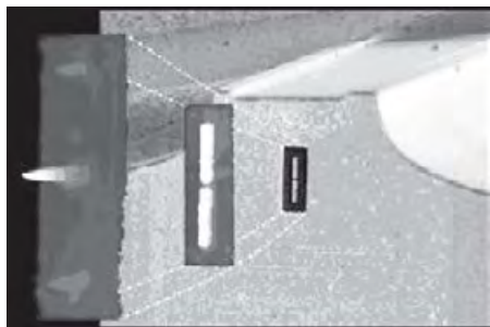
Рис. 5.83. Фасетка квантового каскадного лазера с наноантенной [306]
