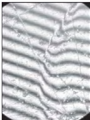
Рис. 4.7. Искривление линий в микроинтерферометре Линника
