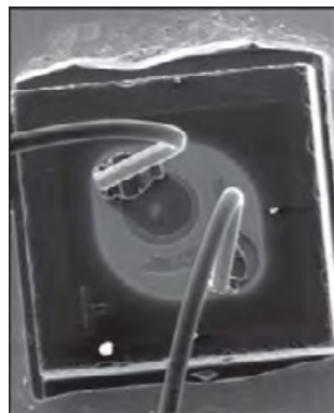
Рис. 5.41. Изображение транзистора КТ3-102 в режиме наведенного тока. Источник: http://www.ga-group.ru
