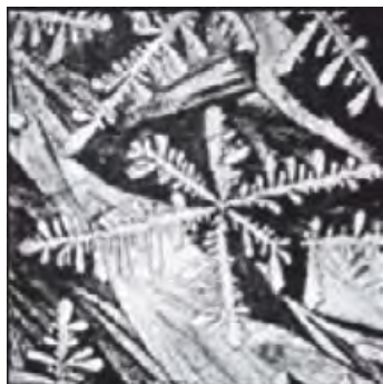
Рис. 3.17. Микрофотография типичного дендрита (увеличение \times 1000 )
