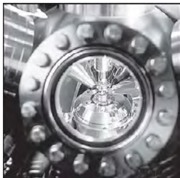
Рис. 5.68. Высоковакуумная камера сканирующего туннельного микроскопа. Источник: http://www.popmech.ru/article/711-tunnel-v-nanomir
