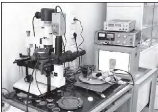
Рис. 5.82. Ближнепольный сканирующий оптический микроскоп Aurora™. Источник: http://spm.unn.ru/equipment/equipmentru.htm
