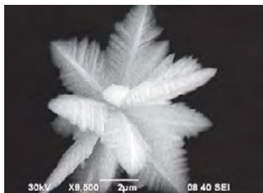
Рис. 3.18. Дендритные фрактальные кристаллиты кобальта. Получены Р. П. Колмыковым. Источник: http://www.nanometer.ru/
