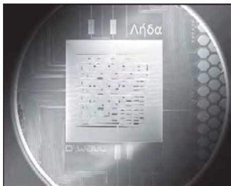
Рис. 2.6. 28-кубитовый чип D-Wave.
