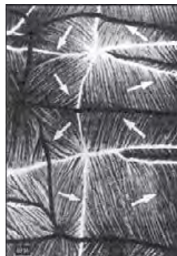
Рис. 5.47. Доменная структура пермаллоевой пленки
