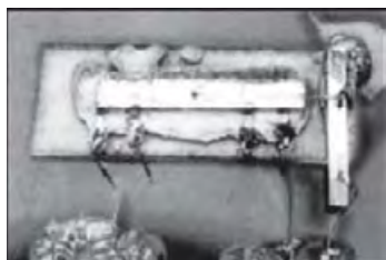
Рис. 1.10. Первая интегральная микросхема Килби
