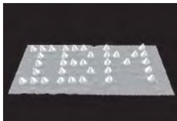
Рис. 5.66. 35 атомов ксенона на никелевой подложке
