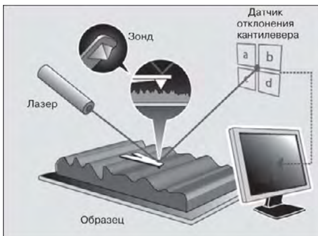
Рис. 5.70. К пояснению работы атомно-силового микроскопа
