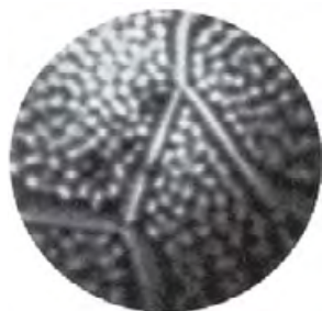
Рис. 5.5. Изображение поверхности иглы из сплава W + 20% Re [275]
