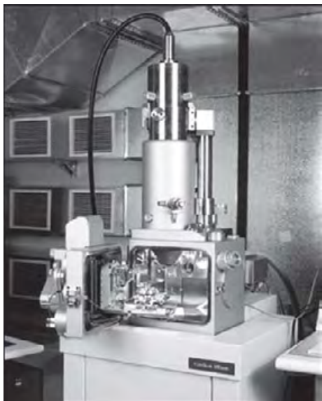
Рис. 5.55. РЭМ CamScan MX2500S с рентгеновским микроанализатором. Источник: http://www.vsegei.ru
