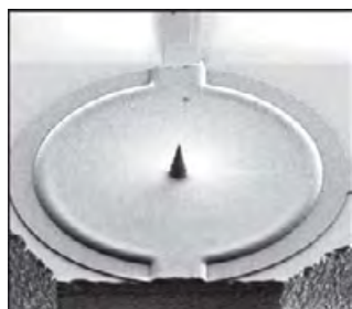
Рис. 5.77. Микрофотография зонда FIRAT™. Источник: http://www.nanometer.ru/2006/11/17/5384379.html
