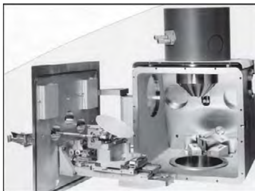
Рис. 5.26. Камера образцов РЭМ. Источник: http://lab.bmstu.ru/rem/parts2/parts2/index.htm
