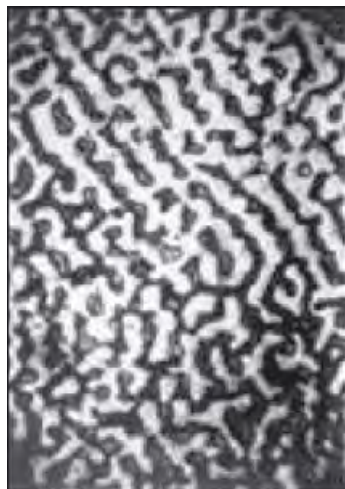
Рис. 3.7. Самоорганизация при облучении лазером сплава Fe-Cr-Ni
