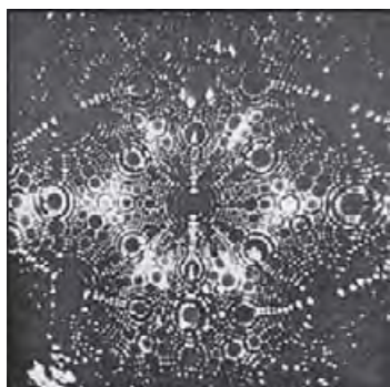
Рис. 5.4. Поверхность кристалла вольфрама в автоионном микроскопе. Источник: http://atom-scale.itep.ru/science/equipment/aim.html
