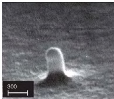
Рис. 5.85. Наностолбик из полимерного материала, РЭМ [309]
