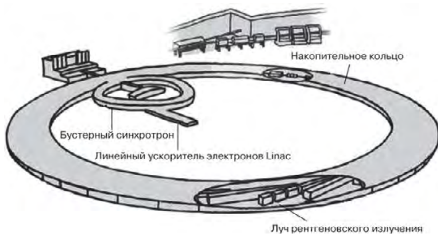
Рис. 5.7. Схема синхротрона ESRF
