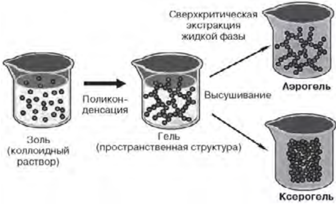
Рис. 3.28. Схема реализации золь-гель-процесса [182]
