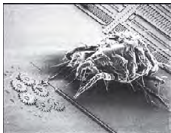
Рис. 1.29. МЭМС в сравнении с клещом. Источник: http://www.nanometer.ru/2008/12/18/nanoazbuka_54965.html
