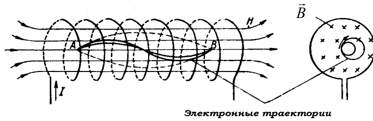
Рис. 5.14. Фокусировка в однородном продольном магнитном поле
