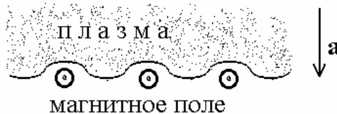
Рис. 4.16. Желобки на границе плазма – магнитное поле. Кружки с точками условно изображают силовые линии магнитного поля
