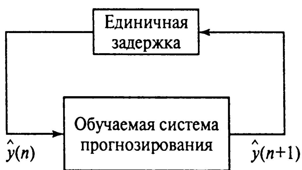
Рис. 14.24. Система одношагового прогнозирования, используемая при итеративном прогнозировании для динамического восстановления хаотических процессов
