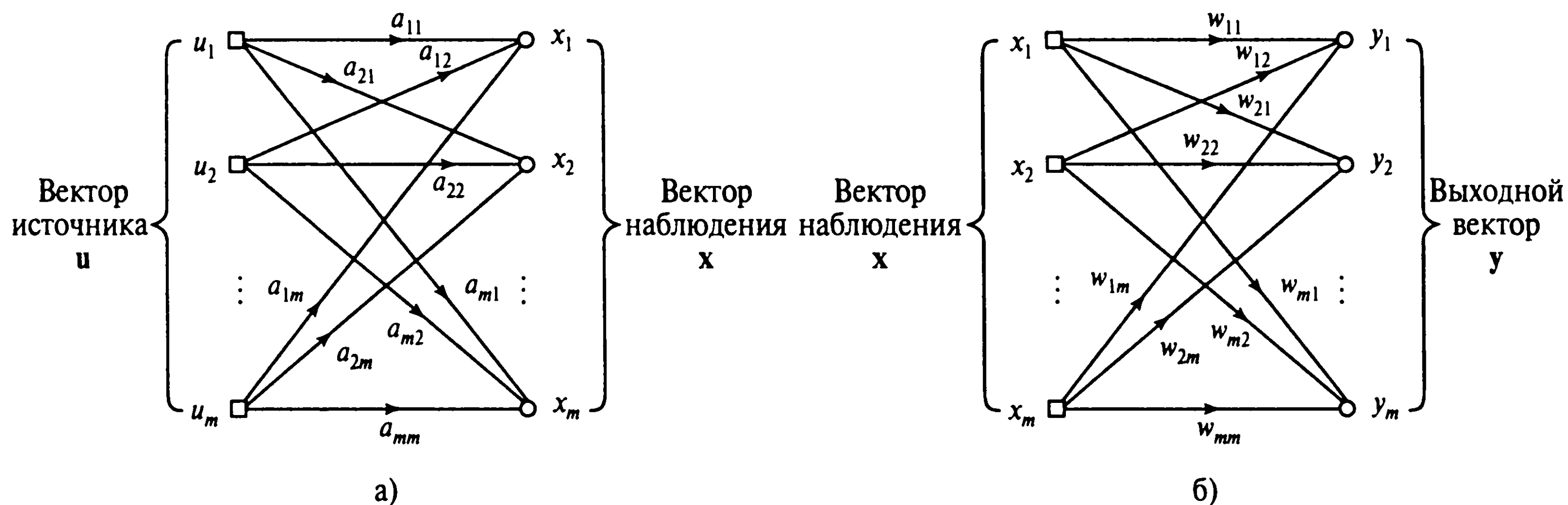
Рис. 10.10. Детализированное описание матрицы смешения (а) и разделяющей матрицы (б)
