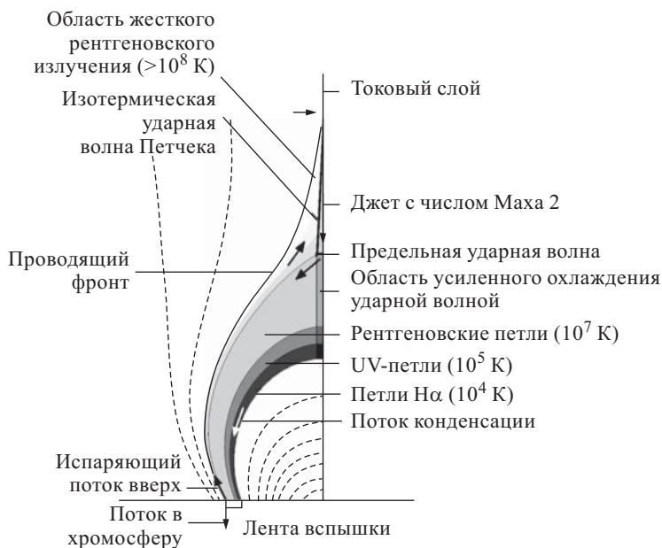
Рис. 11.14. Схематическое изображение системы вспышечных петель, формирующихся пересоединением в сверхмагнитозвуковом режиме. Этот режим наиболее вероятен во время ранней фазы развития вспышки, когда напряжённость пересоединяющихся полей велика. Присутствуют джеты, направленные как к Солнцу, так и от него, но только область ниже джета, направленного к Солнцу, содержит плотную плазму, поскольку в двумерных моделях хромосферное испарение происходит только на тех магнитных силовых линиях, которые лежат ниже X-линии. Сплошными кривыми показаны границы между различными плазменными областями, а пунктирные изображают магнитные силовые линии
