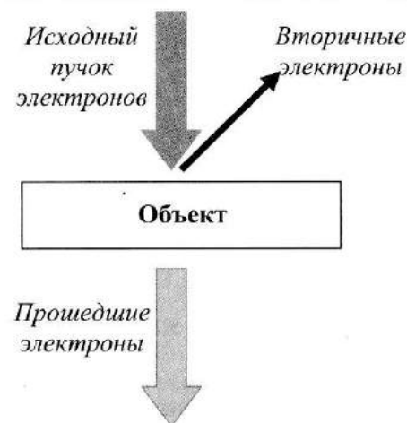
Рис. 4.6. Принципиальная схема электронного просвечивающего сканирующего микроскопа.
