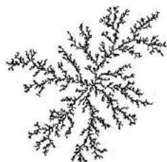
Рис. 1.9. Структура фрактального кластера: модель, состоящая из 10^6 первичных частиц (кластеров).
