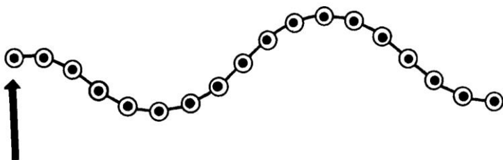
Рис. 7.12 – Колебания гибкой нити в свободном пространстве
