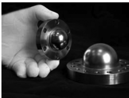
Рис. 6.15. Чертеж и фото бериллиевого окна лабораторного источника рентгеновского излучения.
