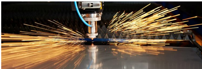
Рисунок 33 – Высокоточная лазерная резка металла. Расплавленный металл выдувается сжатым аргонem
