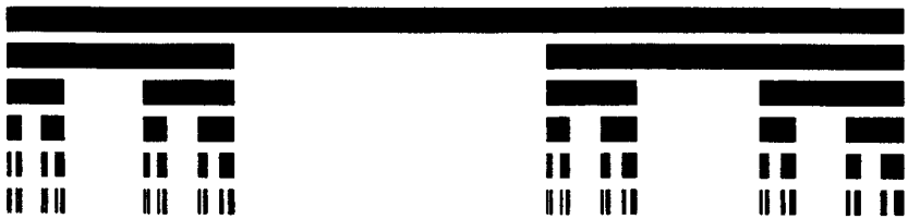
РИС. 5.3. Построение двухмасштабного канторовского стержня с l_1 = 1/4 и l_2 = 2/5 . Фрактальная размерность такого канторовского множества D = 0,6110 .
