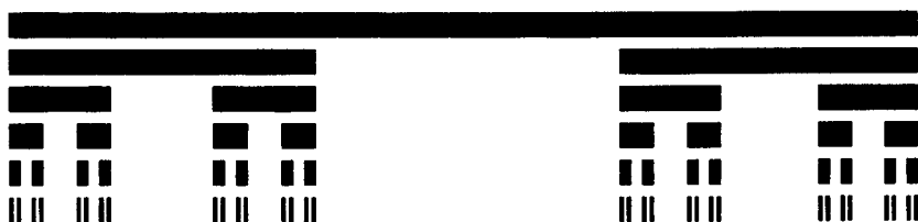
РИС. 5.1. Построение триадного канторовского множества. Затравка – единичный отрезок [0, 1] . Образующий элемент удаляет среднюю треть. На рисунке показаны первые пять поколений. D = \ln 2 / \ln 3 = 0,6309 .
