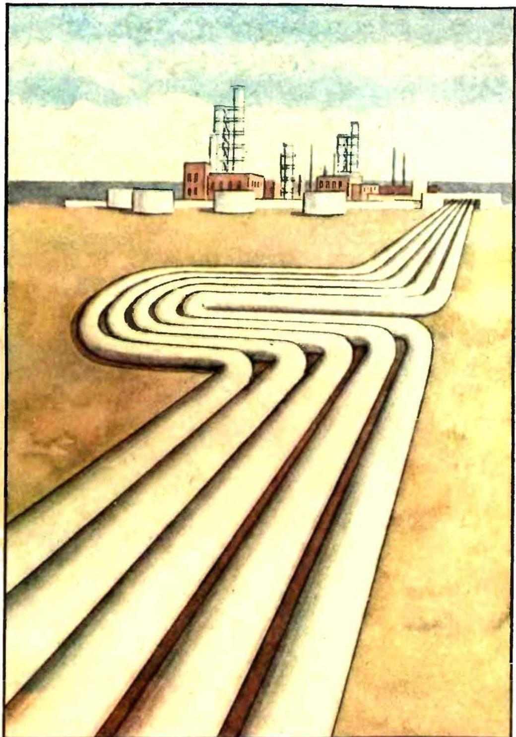
33. Почему при прокладывании системы труб (нефтепровода, газопровода, паропровода) в некоторых местах делают петли?
