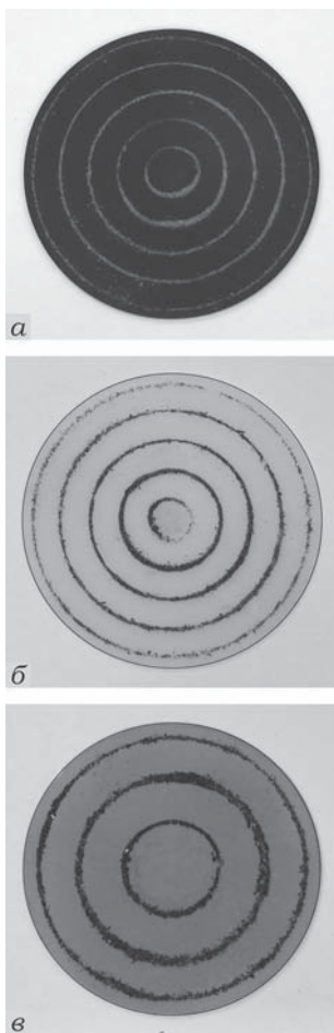
Рис. 10.7. Хладниевы фигуры на круглой пластинке, полученные при возбуждении колебаний в ее центре: а — пластинка из эбонита; б — пластинка из оргстекла; в — пластинка из дюралья
