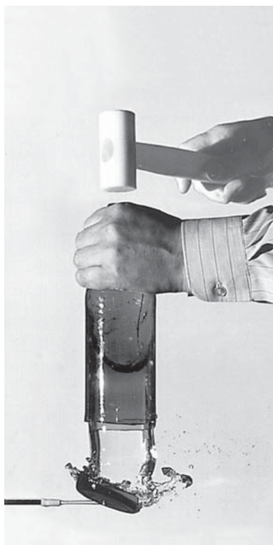
Рис. 12.2. Опыт по наблюдению действия гидродинамического удара на дно бутылки
