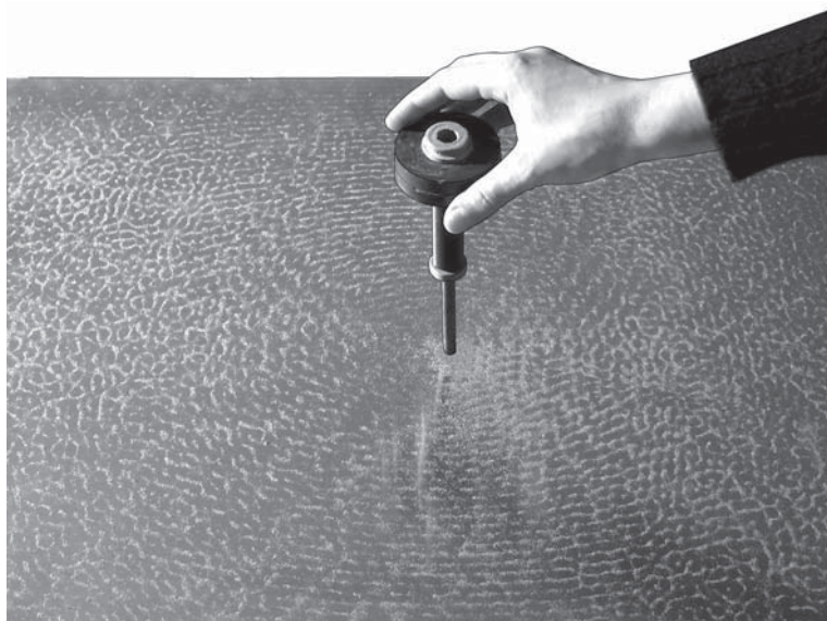
Рис. 10.16. Если ориентированным вертикально вибратором излучателя прикоснуться к посыпанной песком пластинке, то песчинки на ней просто колеблются. Более или менее упорядоченные линии, в которых собирается песок, обусловлены интерференцией волн, идущей от излучателя и отраженных от краев пластинки
