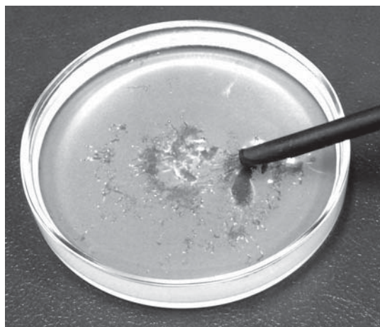
Рис. 13.10. При распространении ультразвука в суспензии крахмала в воде происходит коагуляция — мельчайшие частички крахмала объединяются в относительно крупные комочки
