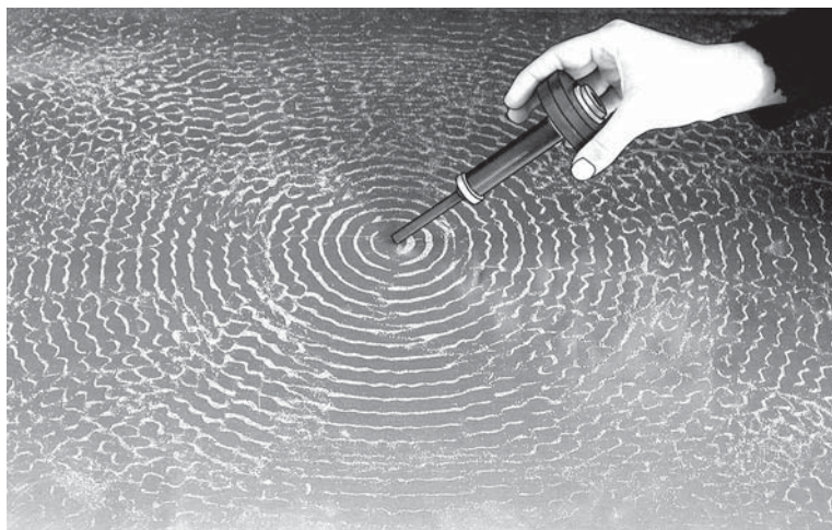
Рис. 10.17. Концентрические линии обозначаются порошком в результате касания поверхности тонкой пластинки наклонным излучателем
