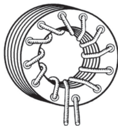
Рис. 3.10. Промышленный магнито-стрикционный излучатель, вибратор которого совершает радиальные колебания
