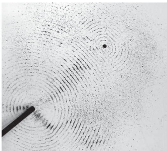
Рис. 11.19. Изгибная волна рассеивается на небольшой неоднородности пластинки, которая сама становится источником круговой изгибной волны
