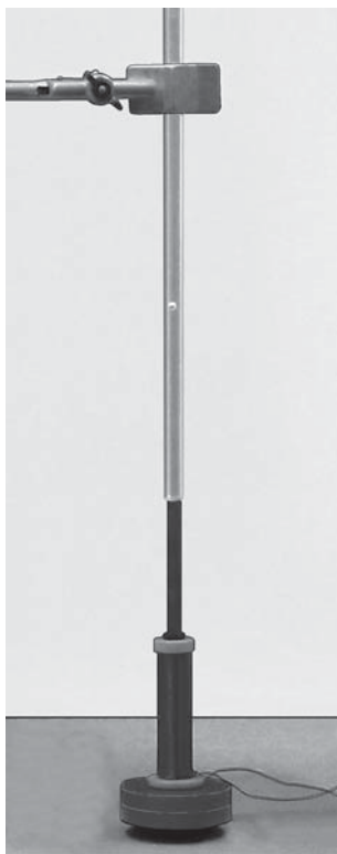
Рис. 5.8. Стальной шарик, находящийся на торце колеблющегося вибратора, высоко подпрыгивает
