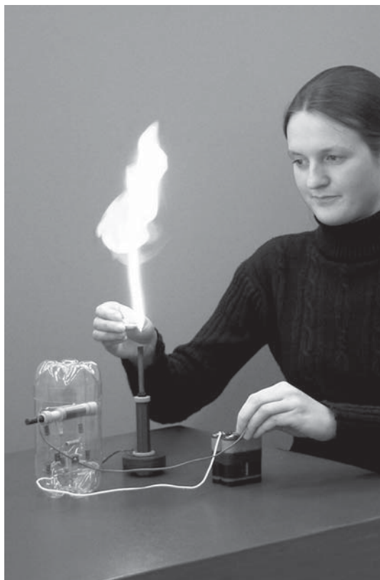
Рис. 13.7. Образование горючей смеси
