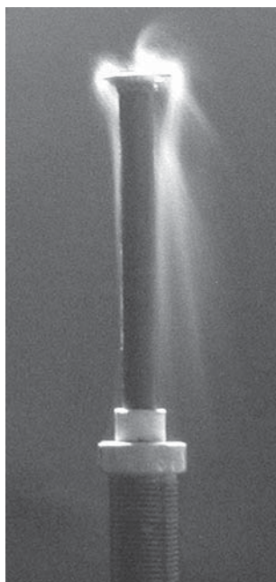
Рис. 13.2. Распыление жидкости с поверхности приклеенного к торцу вибратора диска
