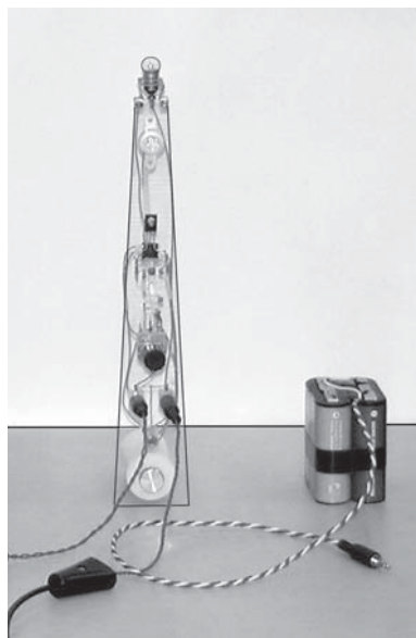
Рис. 2.16. Индикатор интенсивности и фазы звуковой волны
