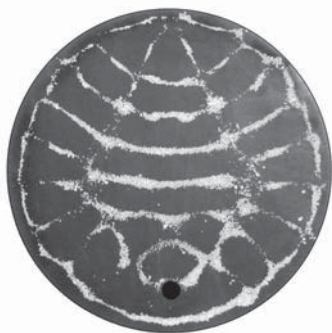
Рис. 10.8. Фигуры Хладни на круглой эбонитовой пластинке, полученные при возбуждении колебаний вблизи ее края
