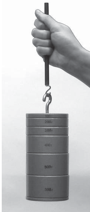
Рис. 13.20. Спай феррита с медью, полученный при использовании ультразвука, выдерживает нагрузку в несколько килограммов
