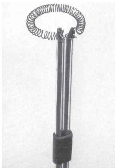
Рис. 1.14. Схематическое изображение теплового автогенератора Рийке: 1 — стеклянная труба; 2 — нихромовая спираль; 3 — стеклянные трубки; 4 — изолянт
