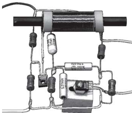
Рис. 4.10. Возможный способ сборки генератора, не требующий значительных временных и материальных затрат
