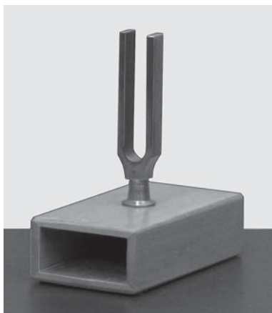
Рис. 1.5. Камертон на деревянном резонаторе; справа схематически изображены возможные колебания его ветвей
