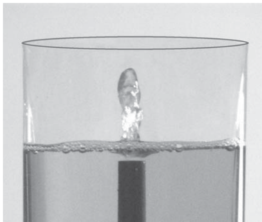
Рис. 7.10. Ультразвуковой фонтан высотой несколько сантиметров, полученный при частоте упругой волны 18 кГц
