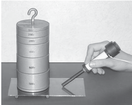
Рис. 5.12. Перемещение массивного груза вибратором магнестрикционного излучателя
