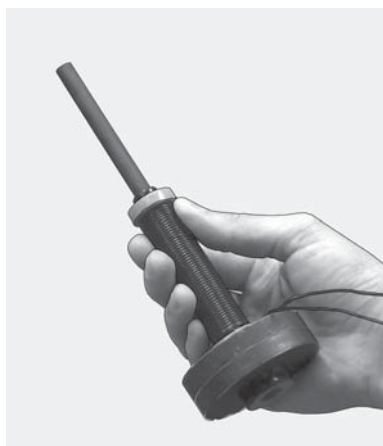
Рис. 3.15. Внешний вид магнитострикционного излучателя
