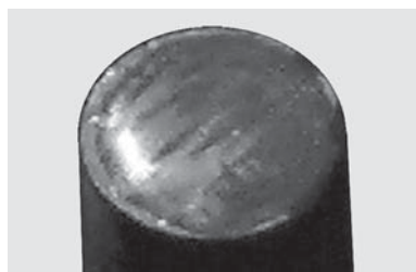
Рис. 13.5. Капиллярные волны на поверхности капли воды, лежащей на торце вибратора
