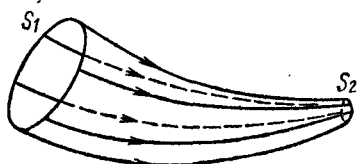
Рис. 14.2. Трубка тока.
