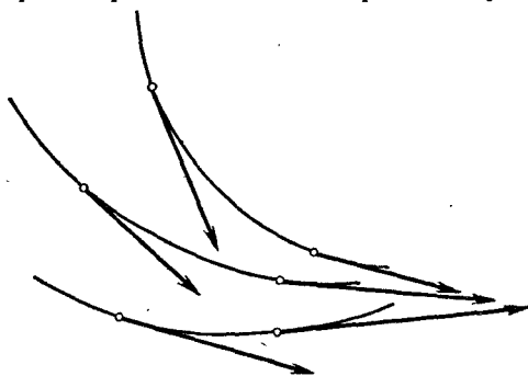
Рис. 14.1. Скорости частиц движущейся жидкости и линии тока.
