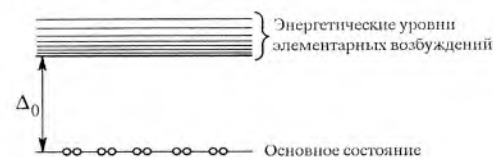
Рис. 3.8. Схематическое изображение энергетического спектра электронных пар
