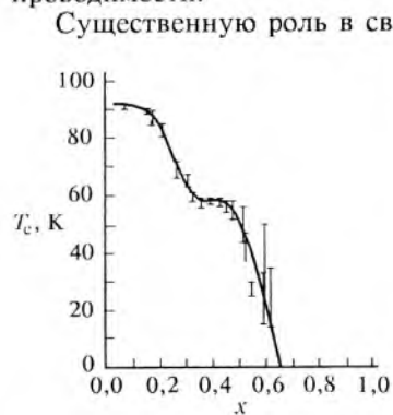
Рис. 6.3. Зависимость T_c от содержания кислорода x в иттриевых купратах YBa_2Cu_3O_{7-x}
