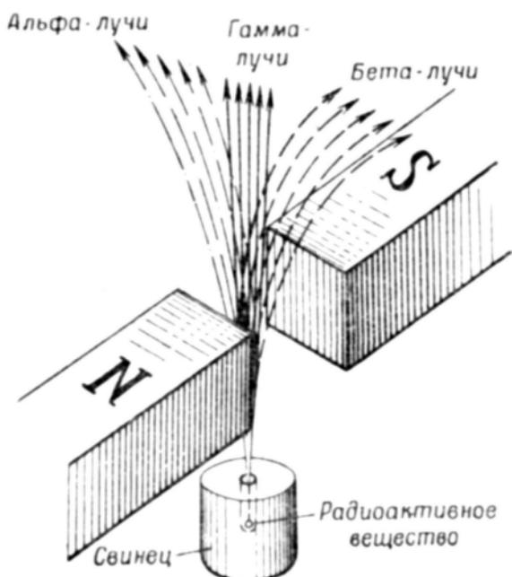
Рис. 3. Схема опыта по разделению радиоактивных лучей в магнитном поле
