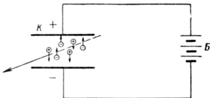
Рис. 7. Принципиальная схема ионизационной камеры.
