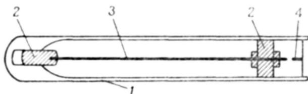
Рис. 9. Карманный ионизационный камера:
