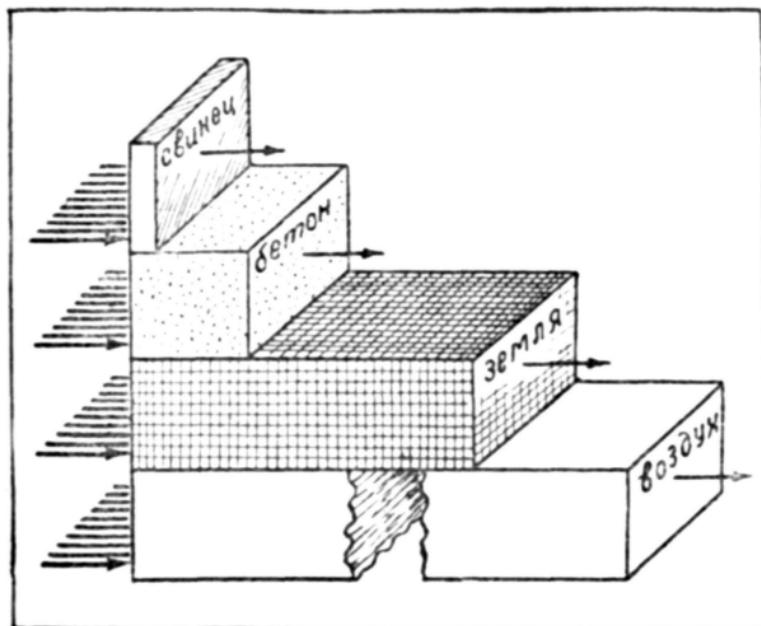
Рис. 4. Ослабление гамма-лучей различными материалами в 10 раз.
