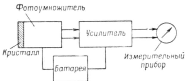
Рис. 12. Простейшая блок-схема сцинтилляционного счетчика.
