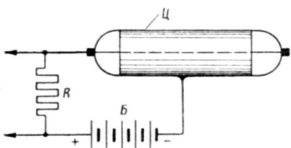
Рис. 10. Газовый счетчик
