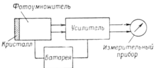
Рис. 12. Простейшая блок-схема сцинтиляционного счетчика.
