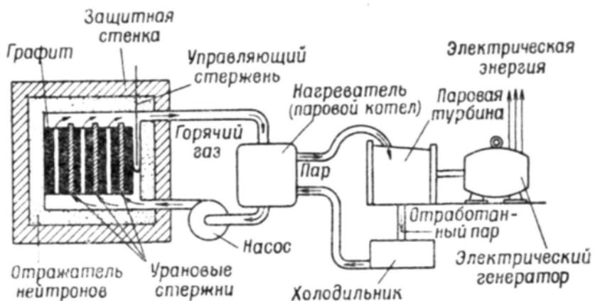
Рис. 22. Принципиальная схема атомной электростанции.
