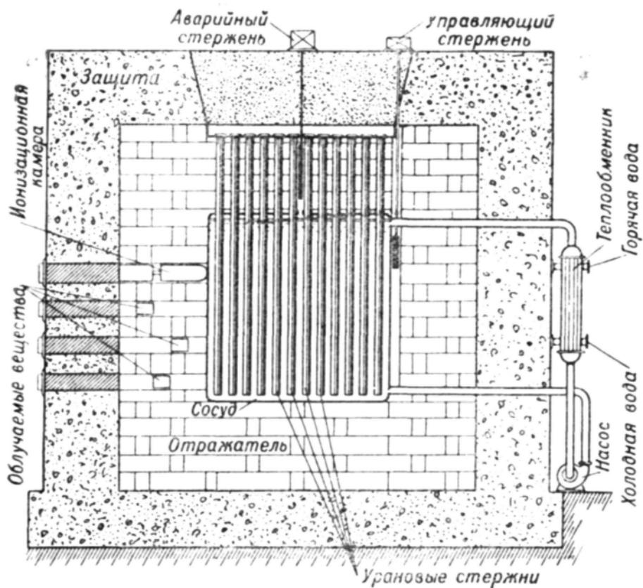
Рис. 23. Схема устройства атомного реактора с тяжелой водой.
