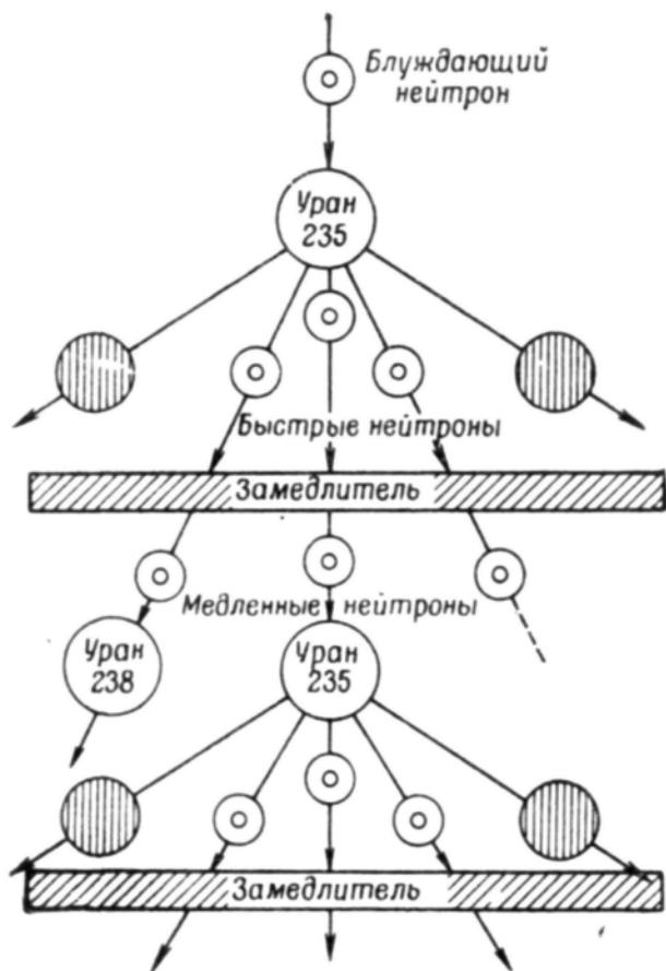
Рис. 20. Схема цепной реакции с замедлителем нейтронов в неразделенном уране.
