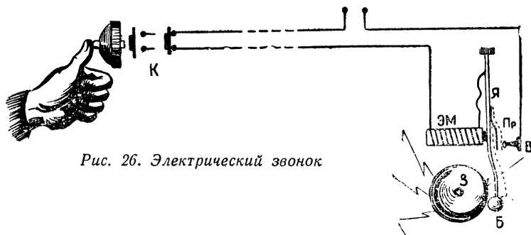
Рис. 26. Электрический звонок
