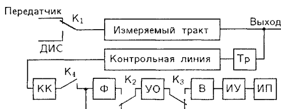
Рис. 20.24. Структурная схема дистанционных измерений: ДИС — датчик измерительных сигналов; Тр — трансформатор; КК — корректирующий контур; Ф — узкополосный режекторный фильтр; УО — усилитель-ограничитель; В — выпрямитель; ИУ — интегрирующая цепь; ИП — измерительный прибор; K_1 \dots K_4 — коммутирующие контакты
