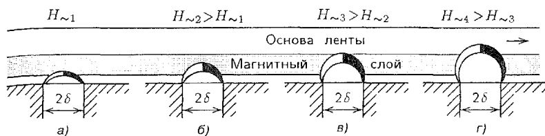
рис. 13.6. Критические зоны (черный цвет) при разных значениях напряженности высокочастотного поля подмагничивания
