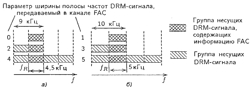
Рис. 18.38. Изображения спектров сигналов DRM при значениях ширины занимаемых ими полос частот, кратных величинам 4,5 кГц (а) и 5 кГц (б)
