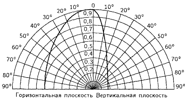
Рис. 10.9. Диаграммы направленности звуковой колонки в вертикальной и горизонтальной плоскостях при F = 1000 Гц
