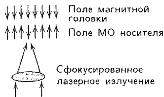
рис. 13.34. К пояснению принципа термо-магнитной записи
