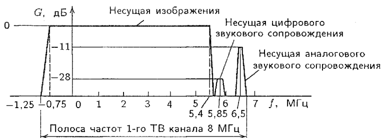
Рис. 17.27. Спектры радиосигнала изображения и звука
