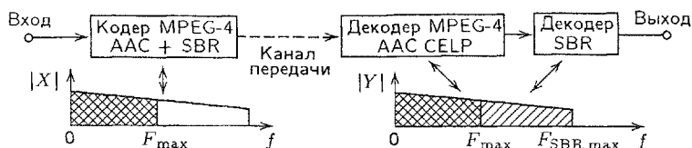
Рис. 18.26. Иллюстрация принципов кодирования и декодирования цифровых звуковых сигналов при использовании методов MPEG-4 AAC и SBR
