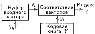
Рис. 18.31. Структурная схема векторного квантователя
