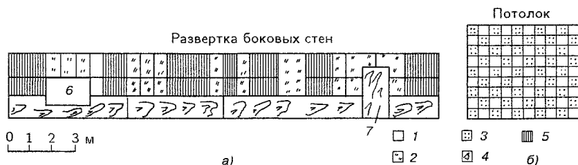
Рис. 5.30. Акустическая обработка поверхностей и потолка речевой студии: а — боковая стена; б — потолок; 1 — щиты из реек с заполнителем; 2 — фанера гладкая с заполнителем; 3 — фанера гладкая без заполнителя; 4 — столлярная плита; 5 — фанера перфорированная с заполнителем; 6 — окно в аппаратную; 7 — дверь в студию
