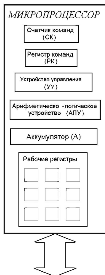
Рисунок 1.2 – Структурная схема микропроцессора
