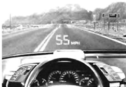
Рисунок 10.5 – Вид через ветровое стекло автомобиля с HUD. Модель Pontiac Bonneville SSEi, 1993 г.
