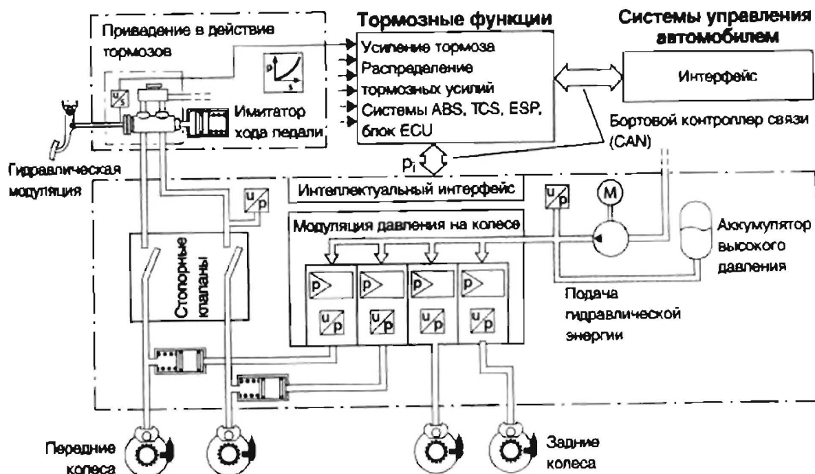
Рисунок 7.3 – Схема электрогидравлической тормозной системы (ЕНВ)
