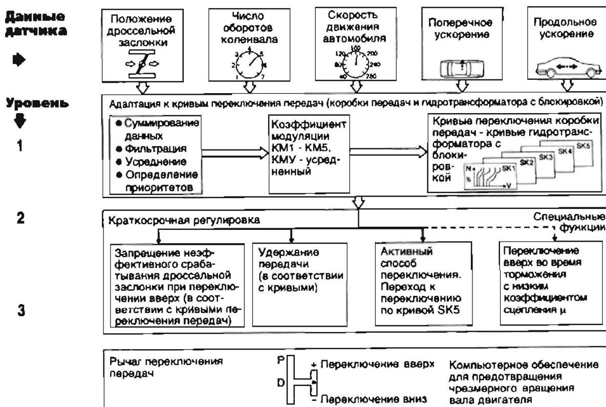
Рисунок 5.1 – Архитектура управления АКП на базе гидротрансформатора[1]
