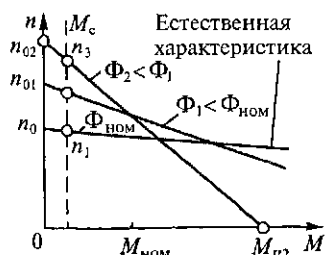
Рис. 10.28. Механические характеристики двигателей параллельного возбуждения при различных потоках возбуждения
