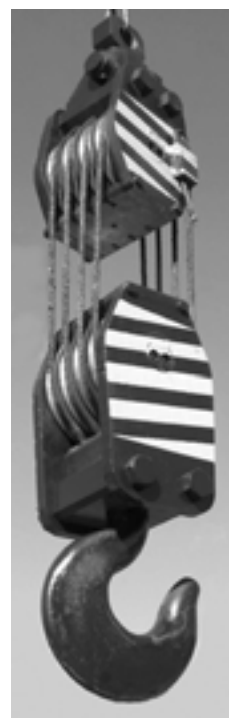
Крюковая подвеска подъёмного крана с полиспастом
