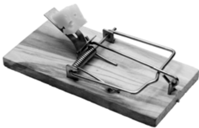
Пружина в установленной мышеловке обладает потенциальной энергией
