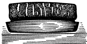
Рис. 56. Дефектоскопия металлических деталей. Видны люминесцирующие трещины
