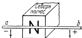
Фиг. 14. Схема опыта получения э. д. с. индукции при движении проводника в магнитном поле
