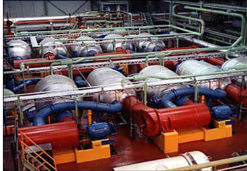
Рис. 200. Цех завода по диффузионному обогащению урана.
