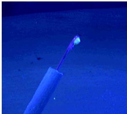
Рис. 38. Свечение в темноте под действием ультрафиолетового света сплава урановой соли со фторидом натрия.
