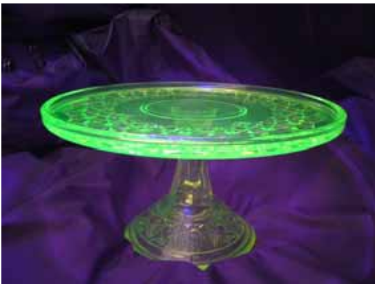
Рис. 44. Флуоресценция уранового стекла в ультрафиолетовом свете.
