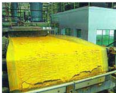
Рис. 96. Производство диураната магния на обогатительной фабрике Jaduguda (восточный Jharkhand, северо-восток Индии).
