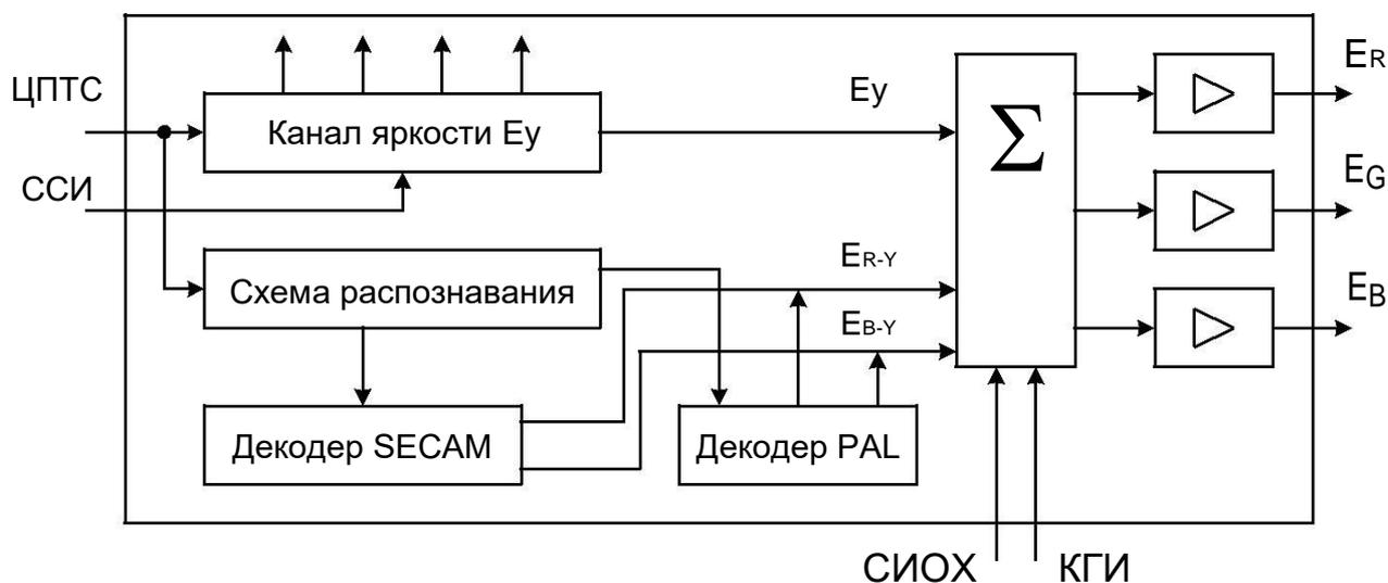
Рис. 19. Функциональная схема модуля цветности.
