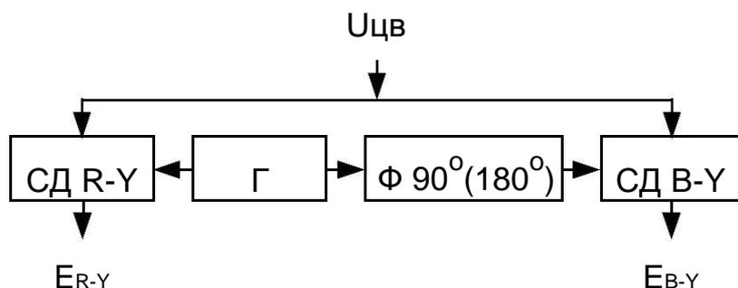
Рис. 21. Функциональная схема декодеров PAL и NTSC.
