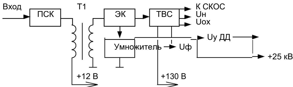
Рис. 18. Функциональная схема МСР.
