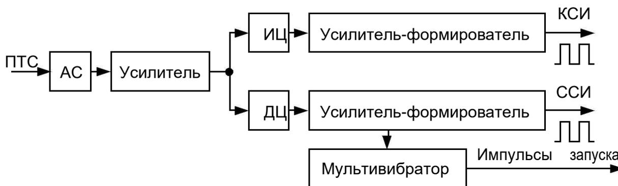
Рис. 12. Функциональная схема канала синхронизации.
