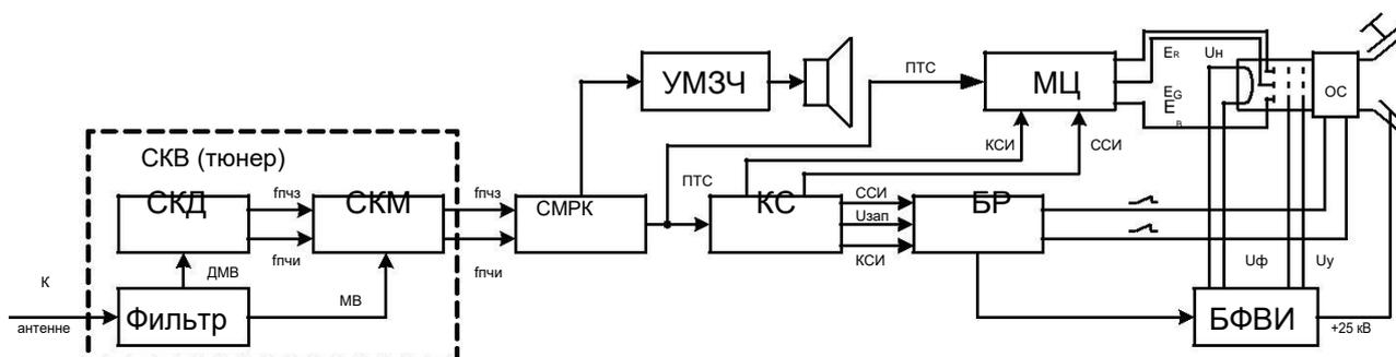
Рис. 7. Структурная схема цветного телевизионного приёмника.
