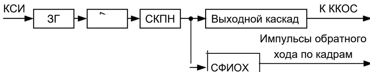
Рис. 15. Функциональная схема модуля кадровой развёртки.
