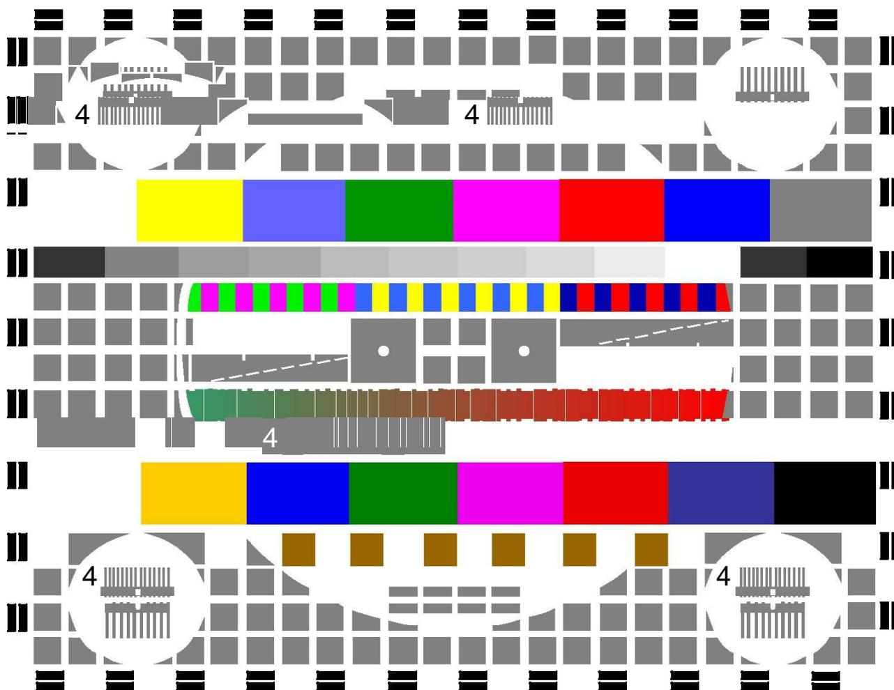
Рис. 24. Универсальная электрическая испытательная таблица (УЭИТ).
