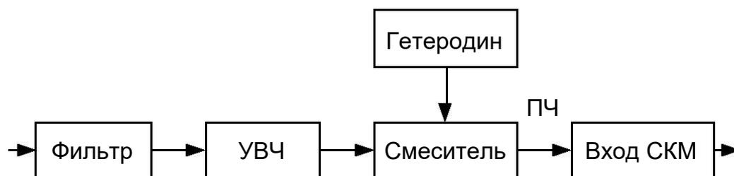
Рис. 9. Функциональная схема селектора каналов.
