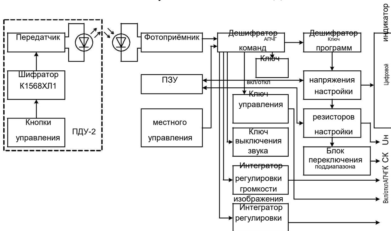
Рис. 27. Структурная схема СДУ.
