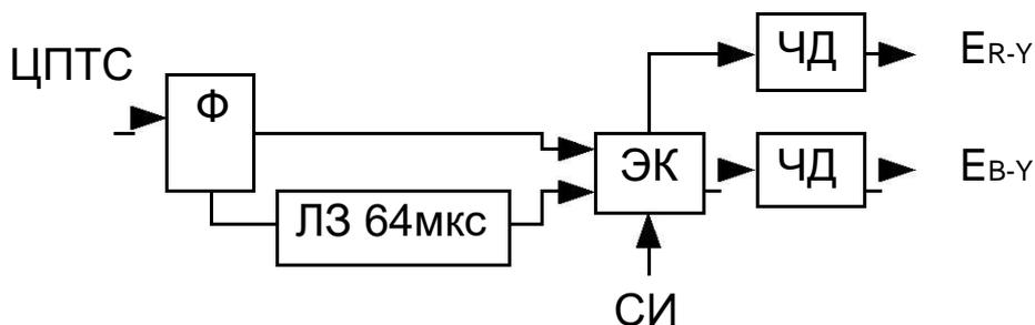
Рис. 20. Функциональная схема декодера SECAM.
