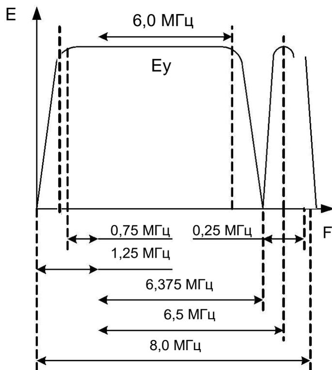
Рис. 4. Частотная характеристика телевизионного сигнала.
