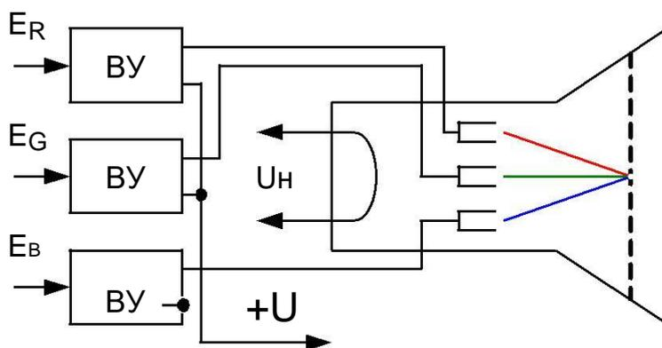
Рис. 22. Функциональная схема видеотракта.
