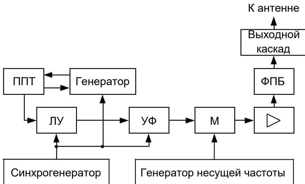
Рис. 3. Функциональная схема телевизионного передатчика.
