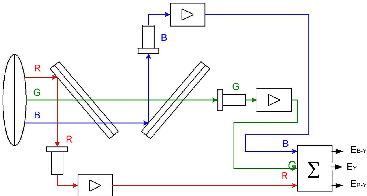
Рис. 5. Схема получения электрических сигналов цветного изображения.
