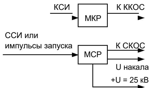
Рис. 13. Функциональная схема блока развёртки.
