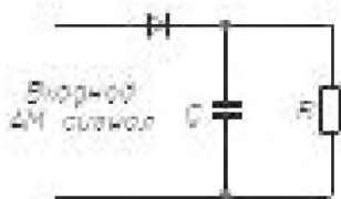
Рис. 1.14. Простой детектор огибающей АМ сигнала
