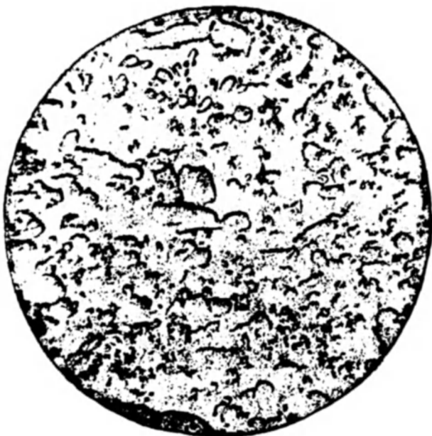
Фиг. 102. Кусок стали, увеличенный в тысячу раз; видны иглы цементита в процессе 'разрушения и окружения.
