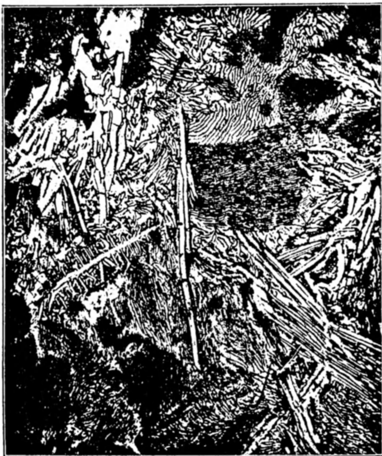
Фиг. 100. Длинные игловидные образования представляют собой кристаллы цементита, составляющие часть всей массы стали.
