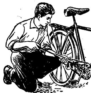
Рис. 14. С помощью распылителя велосипеда и автомобиля опрыскивают керосином, чтобы предохранить их от ржавчины.
