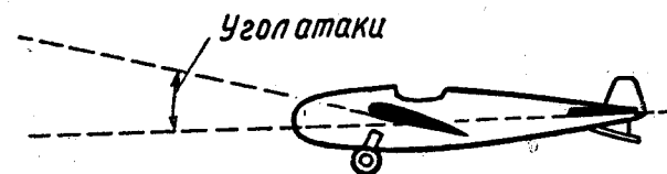
Рис. 72. Установочный угол есть угол между хордой профиля и осью корпуса.
