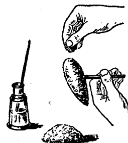
Рис. 42. Сопротивление воздуха увеличивается, если поверхность тела сделать шероховатой.
