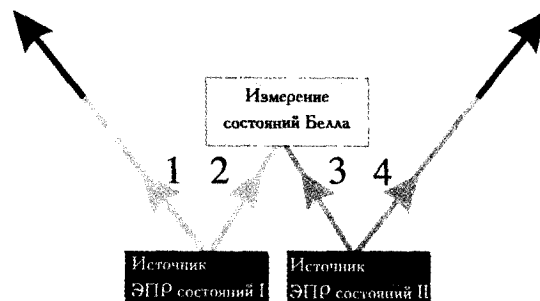
Рис. 3.22. Принцип обмена перепутыванием. Два ЭПР-источника излучают пары перепутанных фотонов 1-2 и 3-4. По одному фотону из каждой пары (фотоны 2 и 3) участвует в процессе измерения состояния Белла. Это приводит к проецированию двух других фотонов 1 и 4 на перепутанное состояние. Изменение насыщенности линий обозначает изменение в наборе возможных предсказаний, которые могут быть сделаны о состоянии частиц.
