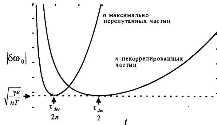
Рис. 7.11. Неопределенность по частоте |\delta\omega_0| как функция длительности одиночного измерения t для максимально перепутанных и некоррелированных частиц. Заметим, что минимальная неопределенность абсолютно одинакова для обеих конфигураций.
