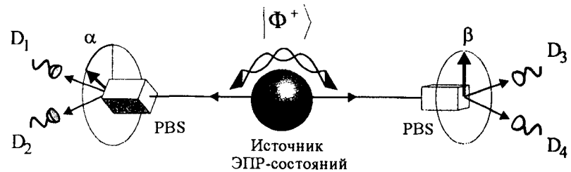
Рис. 1.8. Корреляционные измерения между детектируемыми событиями Алисы и Боба при различных выборах базисов детектирования (обозначенных углами \alpha и \beta ориентаций поляризационных светоделителей PBS) приводят к нарушению неравенств Белла.
