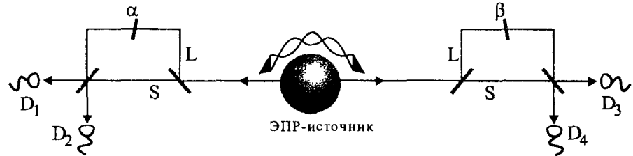
Рис. 3.2. Схема эксперимента типа Фрэнсона, по проверке интерференции перепутанных во времени фотонных пар. Измерения проводятся с помощью двух удаленных разбалансированных интерферометров Маха-Цандера. Фаза каждого интерферометра изменяется фазовращателем, расположенным в длинном ( L ) плече.
