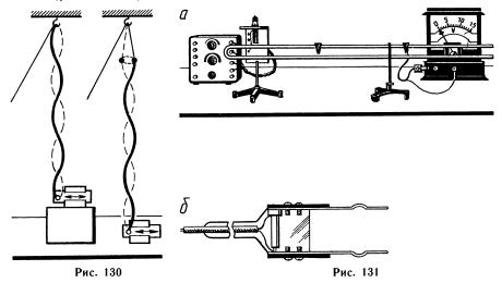
Включают выпрямитель и, передвигая пружинящие контакты вдоль линии, находят узлы и пучности напряжения. Пучности напряжения отмечают бумажными полосками (рис. 131,  $\delta$ ).
