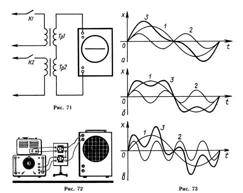
Разомкнув ключ K1, замыкают ключ K2 и наблюдают осциллограмму второго слагаемого колебания.
