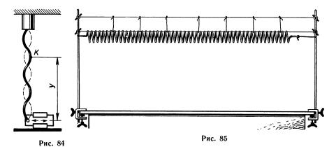
Ударив линейкой по торцу пружины, наблюдают распространение продольной волны. Для большей выразительности опыта следует сзади пружины поставить белый экран или натянуть рулон белой бумаги. Выразительность демонстрации повышается, если пружину спереди осветить.
