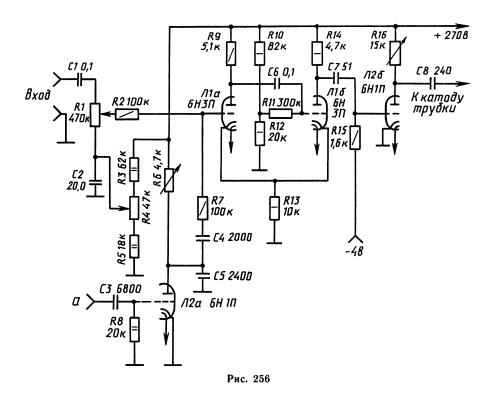
дилось ограничение в отсутствие исследуемого напряжения. В результате этого изменится распределение во времени передних фронтов П-образных импульсов, а соответственно и положение светящихся точек на экране трубки — возникает осциллограмма исследуемого напряжения. Чувствительность осциллографа с описываемым преобразователем составляет примерно 1 см/В.
