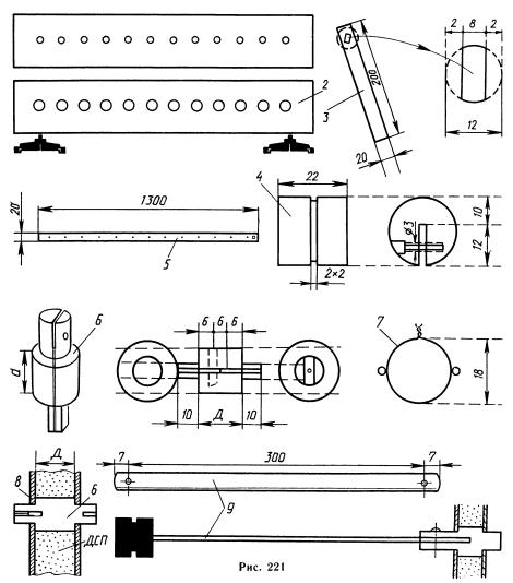
На расстоянии 200 мм от нижнего края основания 2 следует просверлить на равном расстоянии друг от друга 13 отверстий. (В нашем приборе их по ошибке было сделано 12, что создало
