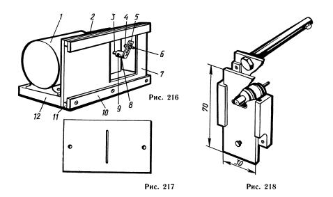
Основание прибора 12 сделано из нескольких листов толстой фанеры, которые склеены казеиновым клеем. Высота основания берется такой, чтобы вал 3 редуктора оказался поднятым над поверхностью стола примерно на 100 мм.
