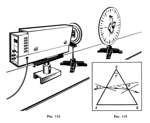
показывают соответствующее изменение угла отклонения. Делают вывод о том, что угол отклонения (рис. 114) зависит от преломляющего угла, показателя преломления материала призмы и угла падения.
