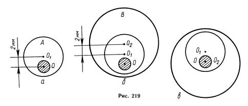
равно 1 мм. Поворотом эксцентрика B можно изменять смещение центра последнего относительно оси вала двигателя в пределах от 0 до 2 мм.
