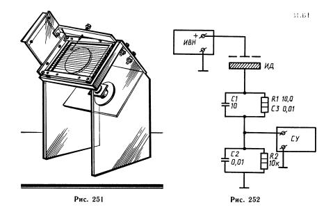
десятков вольт. Этот импульс может иметь положительную или отрицательную полярность в зависимости от подключения в электронной схеме детектора высокоомного резистора R1 к аноду или катоду газоразрядной трубки V1.
