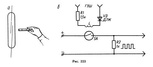
положительные до значения стабилизации. Стабилитрон включен в обратном направлении. Благодаря этому на выходе появляются прямоугольные импульсы с частотой следования в зависимости от частоты настройки генератора и амплитудой, равной напряжению стабилизации.
