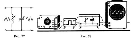
Простейшим анализатором электромагнитных колебаний может служить перестраиваемый колебательный контур с достаточно большой добротностью. На доске рисуют схему последовательного анализатора спектров (рис. 27). На вход перестраиваемого контура подается исследуемый периодический сигнал, а на выход включают индикатор, которым может служить осциллограф.
