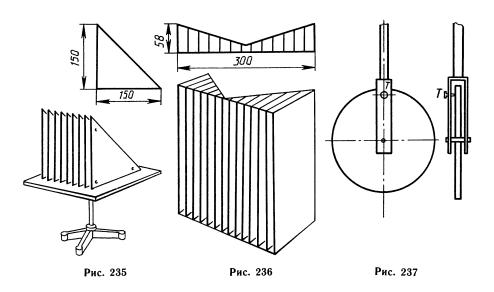
стоянии 23 мм друг от друга. Для крепления пластин надо изготовить деревянный каркас, в верхнем и нижнем основаниях которого делают неглубокие пропилы для металлических пластин. Спереди и сзади призму оклеивают бумагой.
