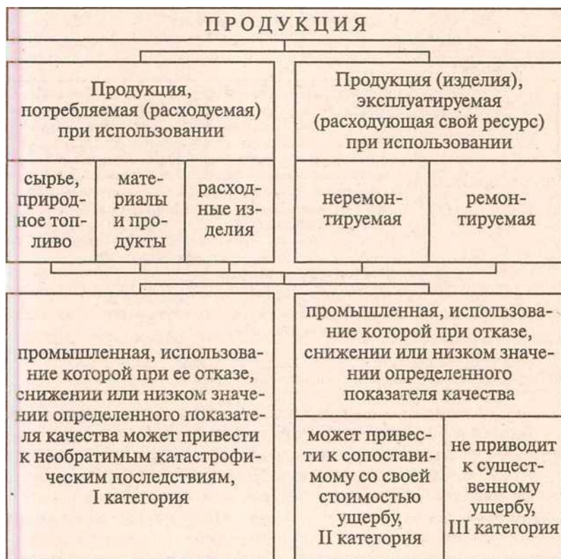
Рис. 2.2.2. Классификация промышленной продукции по признакам ее использования и последствиям от отказа, снижения или низкого значения определенного показателя качества
