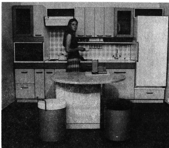
3. Набор "Даша-1". Оснащен электропанелью со световой сигнализацией, жарочным шкафом, холодильником, электроломтерезкой, часами, таймером. Дизайнер Т.А. Суслова. ВНИИТЭ
