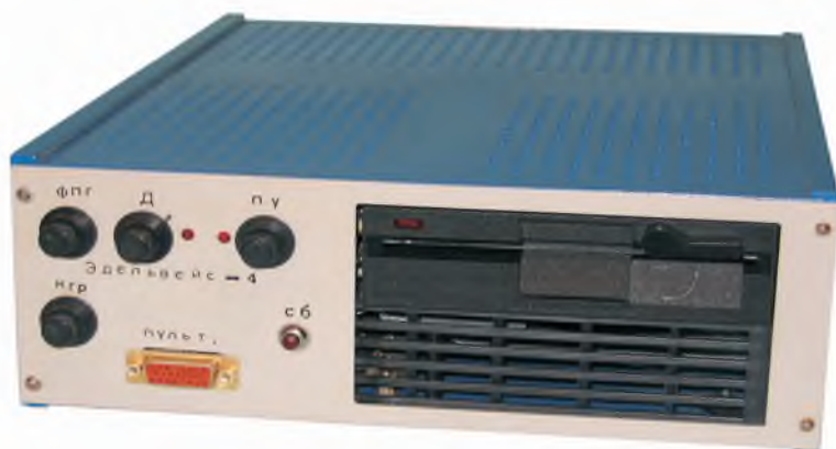
Рис. 9.17. Первый российский компьютерный полиграф «Эдельвейс-4». Авторы проекта В.А. Варламов, Г.В. Варламов
