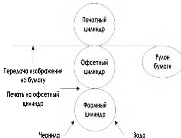
Рисунок 13 - Принцип работы машины для офсетно-литографической печати (при четырехкрасочной печати каждый печатающийся цвет имеет свой набор цилиндров, между которыми располагаются установки для высушивания)
