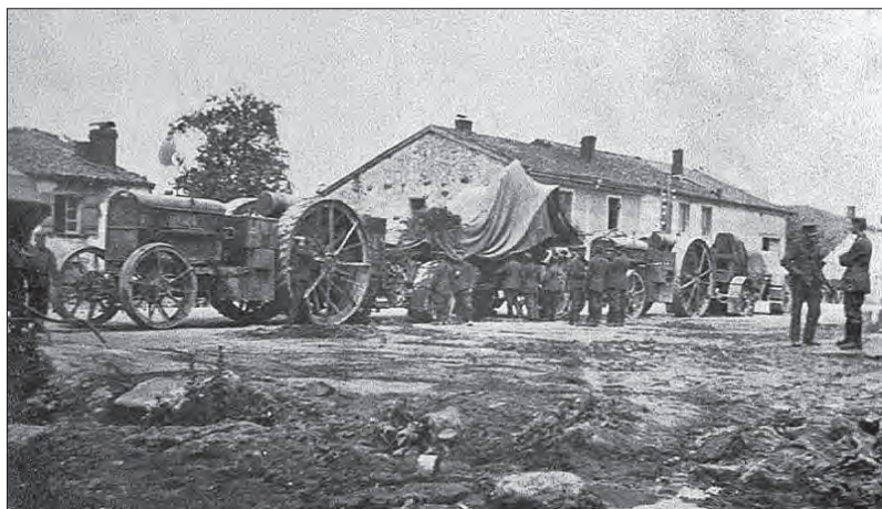
Транспортировка «Большой Берты» — «тип М» тягачами «Даймлер»
