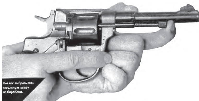
Поочерёдное экстрактирование: так из барабана Нагана выбивались отстрелянные гильзы
