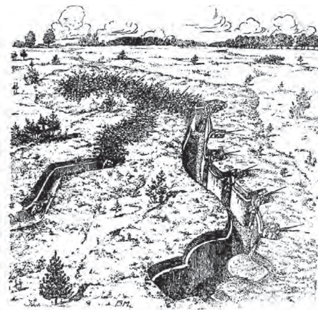
Ячейковый окоп на стрелковое отделение. Левая часть окопа и начало хода сообщения замаскированы. Остальная маскировка не показана.
