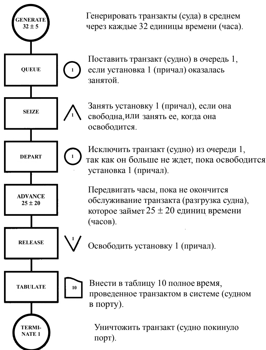
Рис. 1.71. Блочное представление жизни модели (порта) как течение временных транзактов (судов), продвигающихся в модели и обслуживающихся в постоянных устройствах (портовых терминалах) [109, с. 475]: GENERATE – генерирует транзакты через A единиц времени, модифицированных B с задержкой C , D транзактов, с приоритетом E , форматом FB ; QUEUE – обеспечивает занятие B мест в очереди A ; SEIZE – занимает устройство с номером A ; DEPART – обеспечивает освобождение B единиц в очереди A ; ADVANCE – задерживает транзакт на время A \pm B , если B – const, или A \times B , если B – функция; RELEASE – освобождает устройство с номером A ; TABULATE – табулирует значения входящих транзактов в таблице A ; TERMINATE – уничтожает A транзактов
