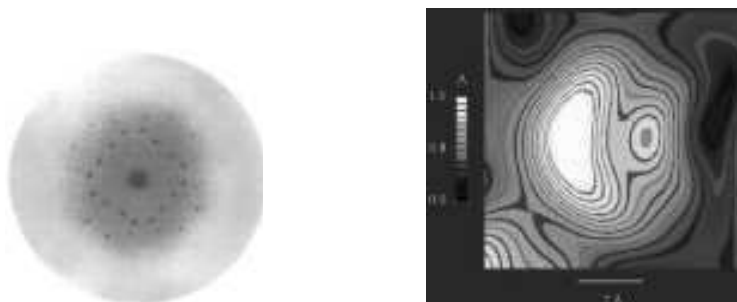
Рис. 3.28. «Картинка» электронной оболочки атома, полученная с помощью сканирующего атомного силового микроскопа 1
