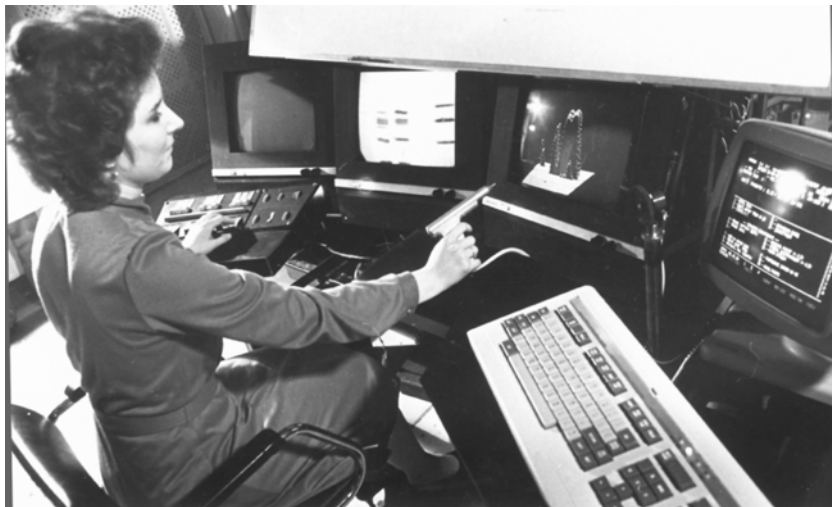
Пульт оператора сканирующей системы АЭЛТ-2/160, позволяющий эффективно подключить компьютер в помощь человеку
