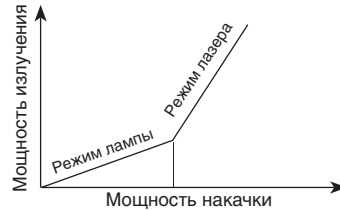
Рис. 19.6. Зависимость мощности излучения от мощности накачки
