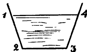
Черт. 25. Поперечный разрез канавы с наклонными стенками.
