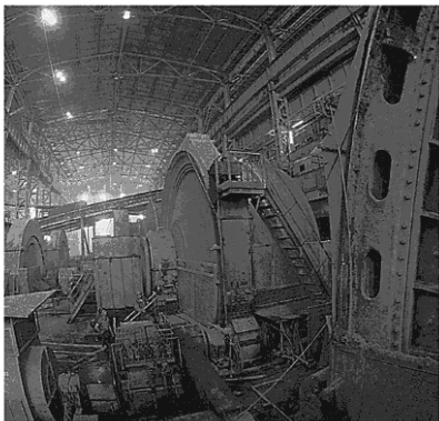
В таких мельницах дробится алмазосодержащая руда — кимберлит
