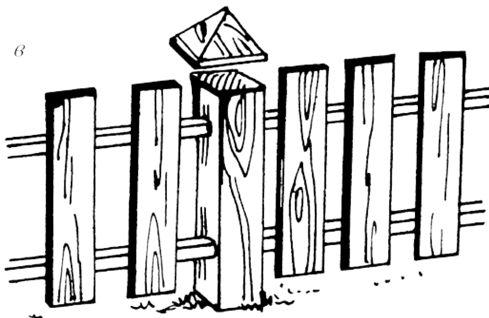
Рисунок 25. Варианты конструкции наветрий (продолжение): б) крышка и колпак для защиты отдельных столбов; в) наветрие из листового железа, согнутого «домиком»
