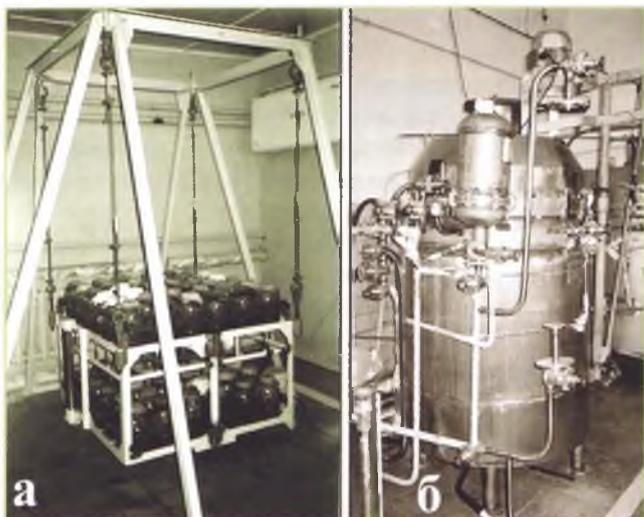
Рис. 1-47. Оборудование для глубинного культивирования микроорганизмов: а – микробиологическая круговая качалка, б – линия ферментёров с полезным объёмом заполнения средой 600 л.
