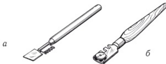
Рисунок 14. Стеклорезы: а) алмазный; б) твердосплавный роликовый
