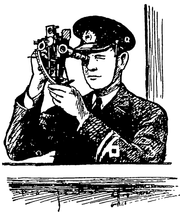
Секстаном определяют высоту солнца над горизонтом.
