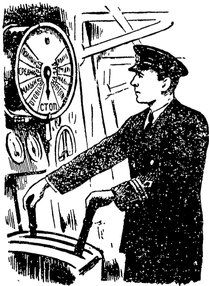
Машинный телеграф передает механику распоряжение капитана.
