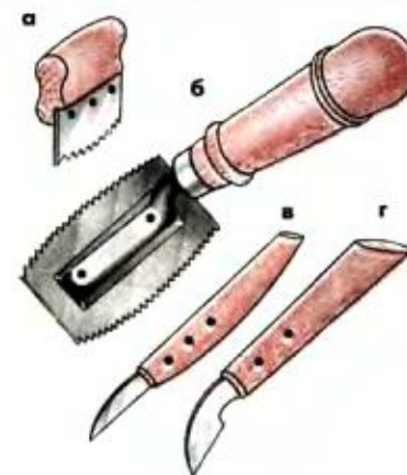
Рис. 178. Инструмент для раскромки шпона: а, б – ножи-пилы; в, г – ножи-резаки
