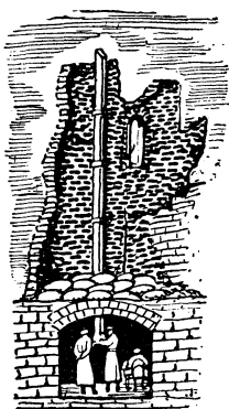
Военный перископ—это длинная труба, в которую наверху и внизу вставлены наклонно зеркала.
