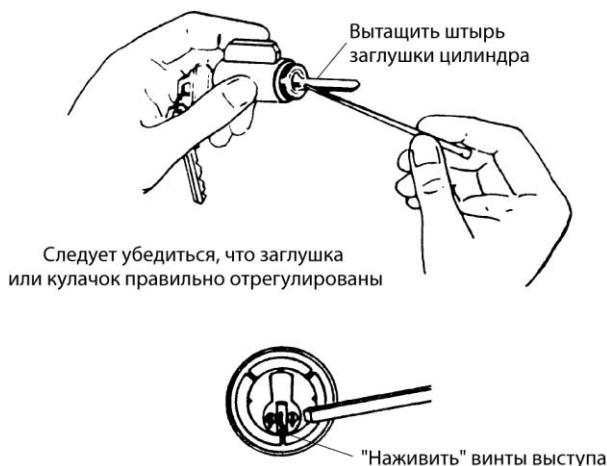
Рис. 4.14. Установка заглушки после изменения секретности цилиндра (С разрешения компании Schlage Lock Company)
