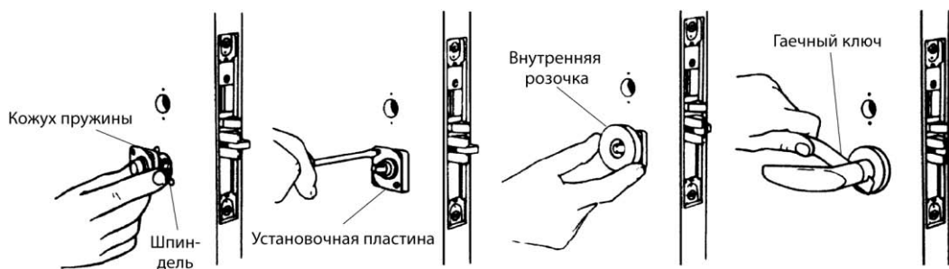
Рис. 6.33. Установка внутренней декоративной накладки (С разрешения компании Schlage Lock Company)
