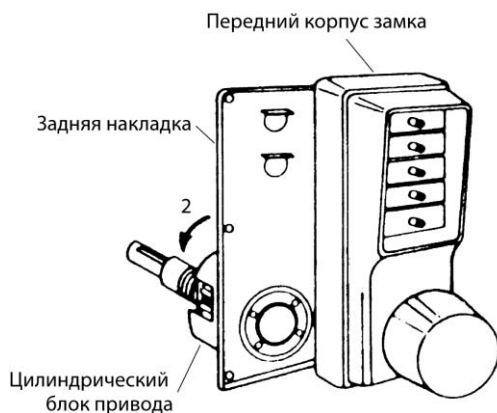
Рис. 8.15. Изменение ориентации замка (С разрешения компании Simplex Access Controls Corp.)
