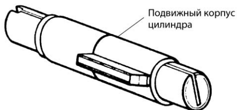
Рис. 7.34. Надвиньте корпус цилиндра на установочный стержень (С разрешения компании Schlage Lock Company)
