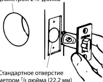
Рис. 6.5. Просверливание двух отвер- стий в двери (С разрешения компании Schlage Lock Company)
