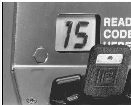
Рис. 15.7. Величину сопротивления резистора в ключе с системой VATS можно определить, вставив ключ в систему All-Lock A-7000 (С разрешения компании A-1 Security Manufacturing Corp.)
