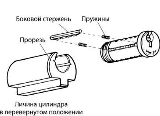
Рис. 7.26. Вставка личины верхней стороной вниз (С разрешения компании Schlage Lock Company)
