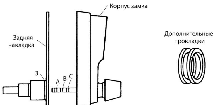
Рис. 8.14. Регулировка замка в соответствии с толщиной двери (С разрешения компании Simplex Access Controls Corp.)
