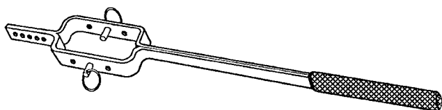
Рис. 5.35. Приспособление для сверления сейфа (С разрешения компании Keedex Mfg)
