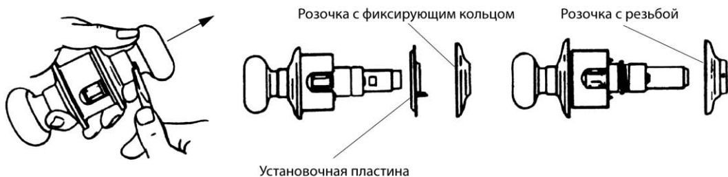
Рис. 6.8. Снятие розочки (С разрешения компании Schlage Lock Company)
