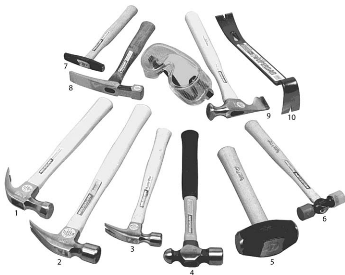
Рис. 5.1. Каждому слесарю-замочнику необходим набор молотков и фомок: 1 — обычный молоток-гвоздодер; 2 — молоток для вырубки; 3 — молоток для чистовой обработки; 4 — молоток с шаровым и фасонным бойком; 5 — молоток для пробойника; 6 — молоток с мягкими насадками на бойке; 7 — магнитный молоток для гвоздей с большой шляпкой; 8 — молоток для каменщика; 9 — молоток для гипсокартона (сухой штукатурки); 10 — фомка (С разрешения компании Vaughan & Bushnell Manufacturing Company)
