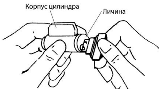
Рис. 4.13. Проверить новый ключ после изменения секретности цилиндра (С разрешения компании Schlage Lock Company)
