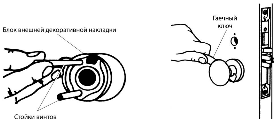
Рис. 6.34. Вставка стоек под винты (С разрешения компании Schlage Lock Company)
