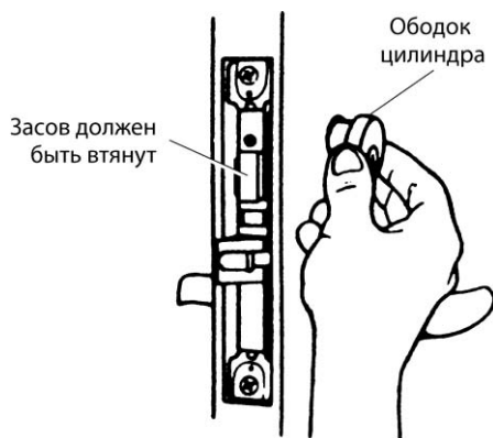
Рис. 6.36. Установка цилиндра (С разрешения компании Schlage Lock Company)
