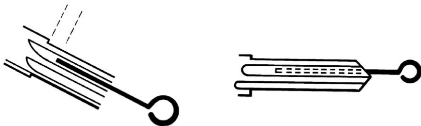
Рис. 14.5. Вставка вспомогательного стержня в канавку на обратной поверхности ключа: вставить стержень в канавку, не доводя его конец до заплечика ключа на 1/8 дюйма (3 мм) и зажать в тисках станка (С разрешения компании Ilco Unican Corp.)
