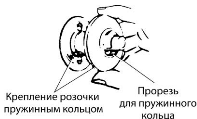
Рис. 6.11. Установка декоративной накладки и розочки (С разрешения компании Schlage Lock Company)
