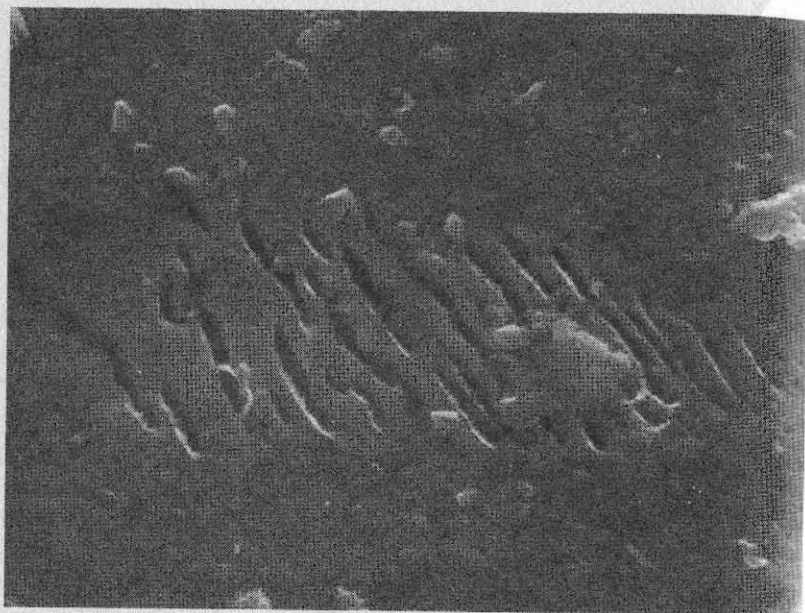
Рис. 41. Электронно-микроскопический снимок магнетита, магнетитовый пироксенит, рудопоявление Рудьма, увел. 8600 На снимке видны параллельные щелевидные углубления (черное)
