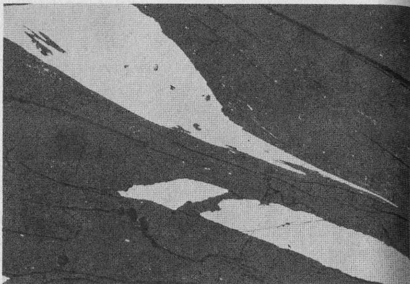
Рис. 47. Клиновидные выделения галенита (светлое) в чароите (серое); шлиф, увел. 80, без анализатора
