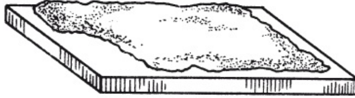
Рис. 54. Укладка раствора на тыльной стороне плитки
