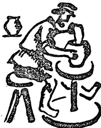
Гончарный станок — это круглая доска, вращающаяся на оси. Приводится он в движение ногой. Гончар кладет кусок теста на середину доски и, вдавив большой палец внутрь теста, придерживает его остальными пальцами снаружи.
