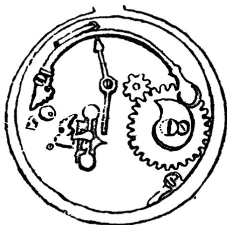
а колёсико, в свою очередь, вращает большое колесо и барабан. Другие колёса, передающие движение стрелке, спрятаны под пластинкой, закрывающей от нас внутреннюю часть механизма. Налево — маленький балансир с двумя грузиками, вроде того бруса с грузами, который был в больших часах.
