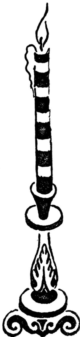
способ. Время определяли по количеству масла, сгоревшего в лампе, или воска в свече. Одно время «огненные часы» стали настолько употребительны, что на вопрос: «сколько времени?» отвечали: «одна свеча» или «две свечи». Ночь разделили на три свечи, и сказать, что сейчас две свечи, было все равно, что сказать: прошло две трети ночи. Были в ходу также лампы и свечи с делениями, которые служили для более точного отсчета часов.
