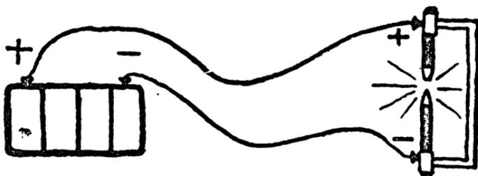
Петров сделал однажды такой опыт. Он взял две угольные палочки. Одну соединил проволокой с плюсом, а другую с минусом. Когда он сблизил концы этих палочек, ток перепрыгнул через воздушный промежуток с одной на другую.
