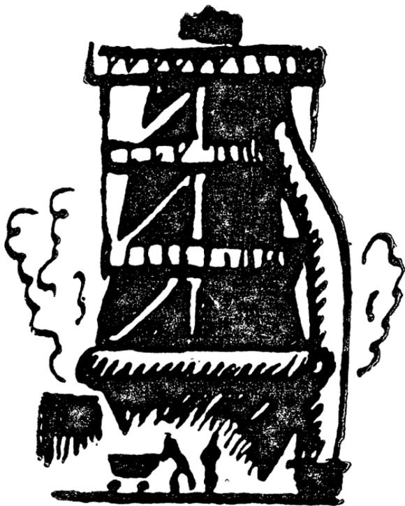
Уголь накаливается добела и отнимает у руды кислород. При этом железо выплавляется из руды и стекает вниз, на дно печи.
