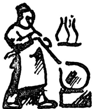
Положим, надо сделать бутылку. Рабочий вкладывает пузырь в форму и дует в трубку до тех пор, пока пузырь не заполнит форму, прилегая к ее стенкам. Когда бутылка остынет, ее легко вынуть; для этого форма устраивается разъемной. Конечно, раньше надо отрезать бутылку от выдувной трубки. Чтобы это сделать, нужно только провести по горячему горлышку холодным железным прутом.
