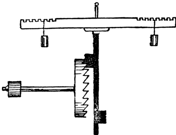
Здесь нарисовано это колесико. Вертушкой служит здесь ось с двумя лопаточками. Сейчас верхняя лопаточка застряла между двумя верхними зубцами. Зубец, которому лопаточка мешает пройти, толкает ее вперед. От этого ось поворачивается на полоборота, и нижняя лопаточка застревает между двумя нижними зубцами. Так дело идет и дальше. А для того, чтобы колесику не так-то легко было вращать вертушку, на верхний конец оси насажен брус с двумя грузиками.
