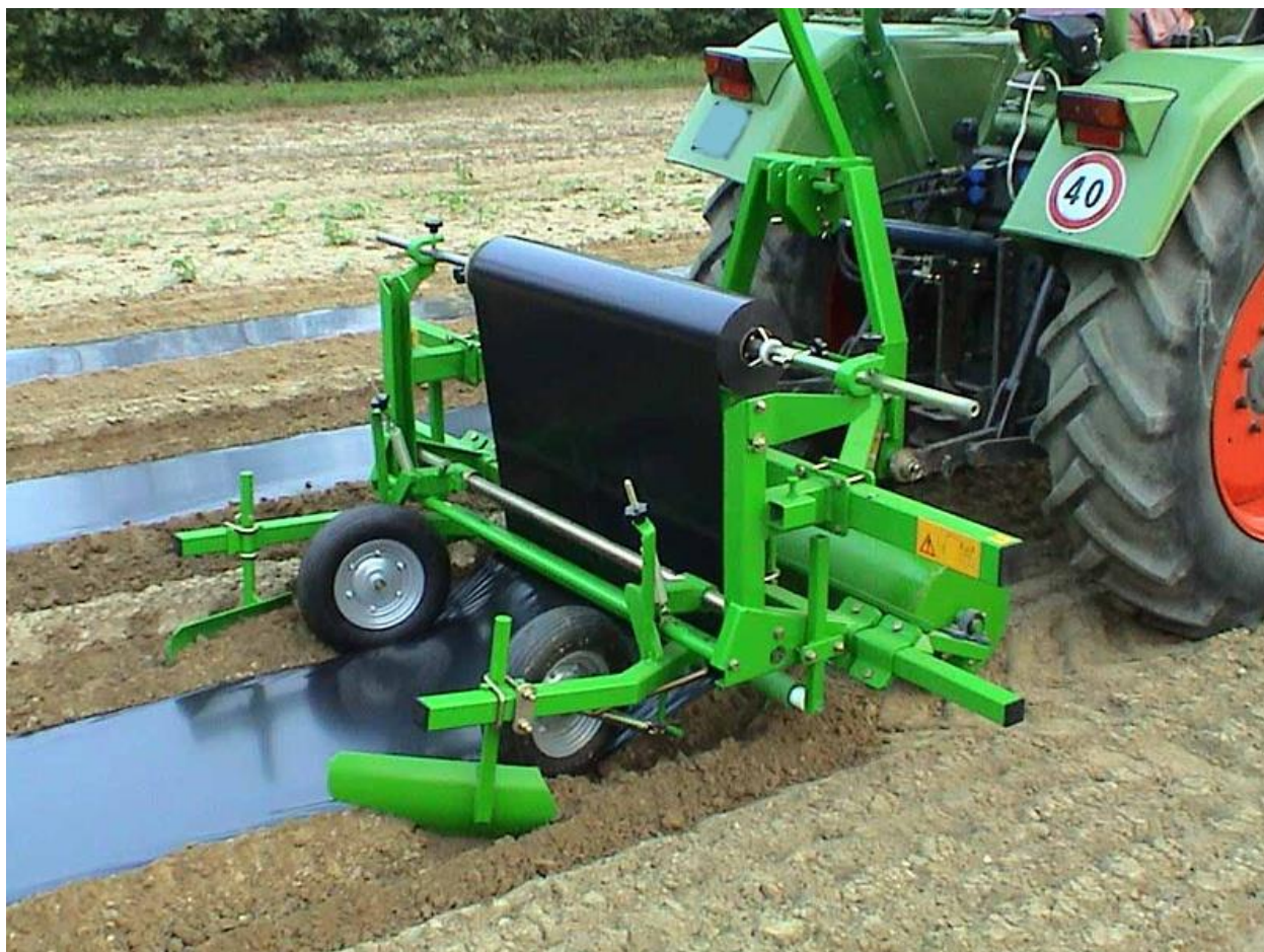
Рисунок 38 – Укладывание пленки перед посадкой рассады земляники садовой
