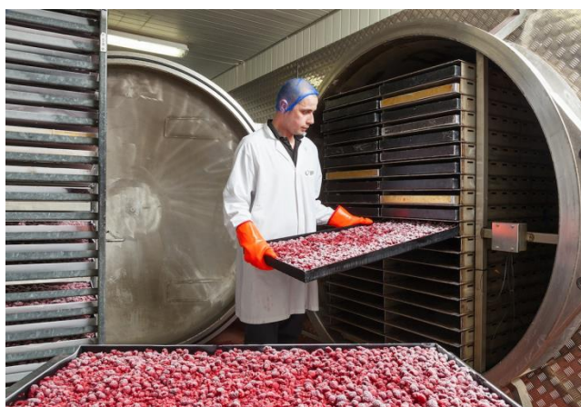
Рисунок 91 - Вакуумная сублимационная сушка и сушеные плоды
