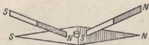
Рис. 12. Схема намагничивания стрелки компаса
