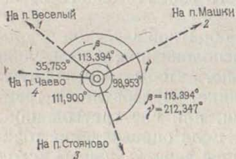
Рис. 126. Схема для решения обратной засечки
