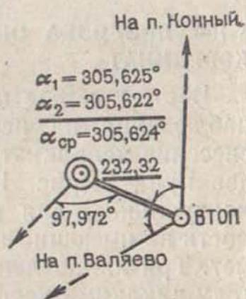
Рис. 129. Схема для вычисления привязки «усом»
