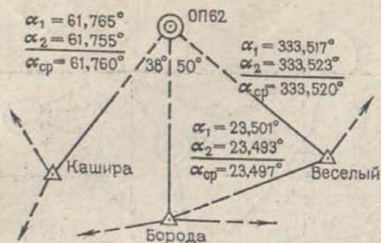
Рис. 123. Схема вычисления дирекционных углов при прямой засечке
