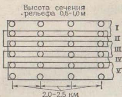
Рис. 138. Схема расположения высотных опознаков при съемке в масштабах 1 : 5000—1 : 500 (ОПВ и ОВ показаны одним условным знаком)
